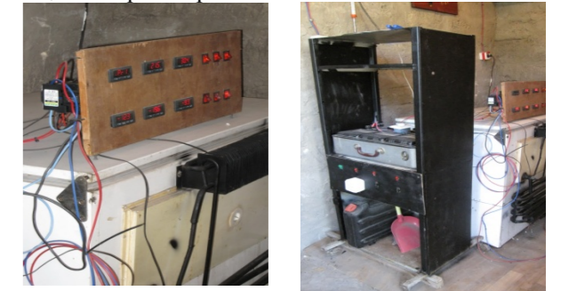
Рис.2. Внешний вид экспериментального стенда на базе абсорбционного холодильника типа «Ларь» вместимостью охлаждаемого объема 100 дм 3
