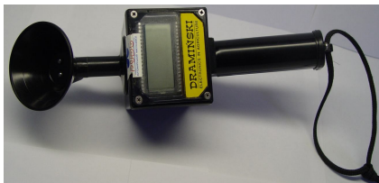
Рис. 5.20 – Зображення електронного визначника маститу у корів (Draminski).
