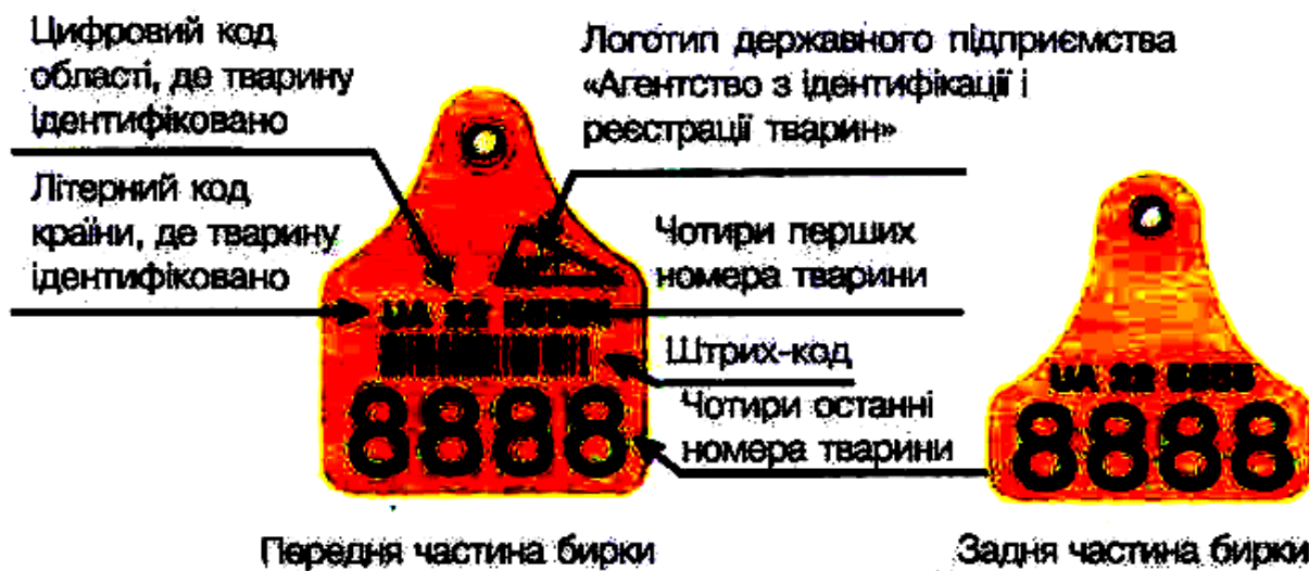
Рис 6. Розташування та значення цифрових, літерних та штрихових кодів на бирках
