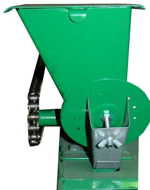
Рис. 2.18. Загальний вид щіткового висіваючого апарату селекційної сівалки СОМ-3/2Х30 (вид збоку)
