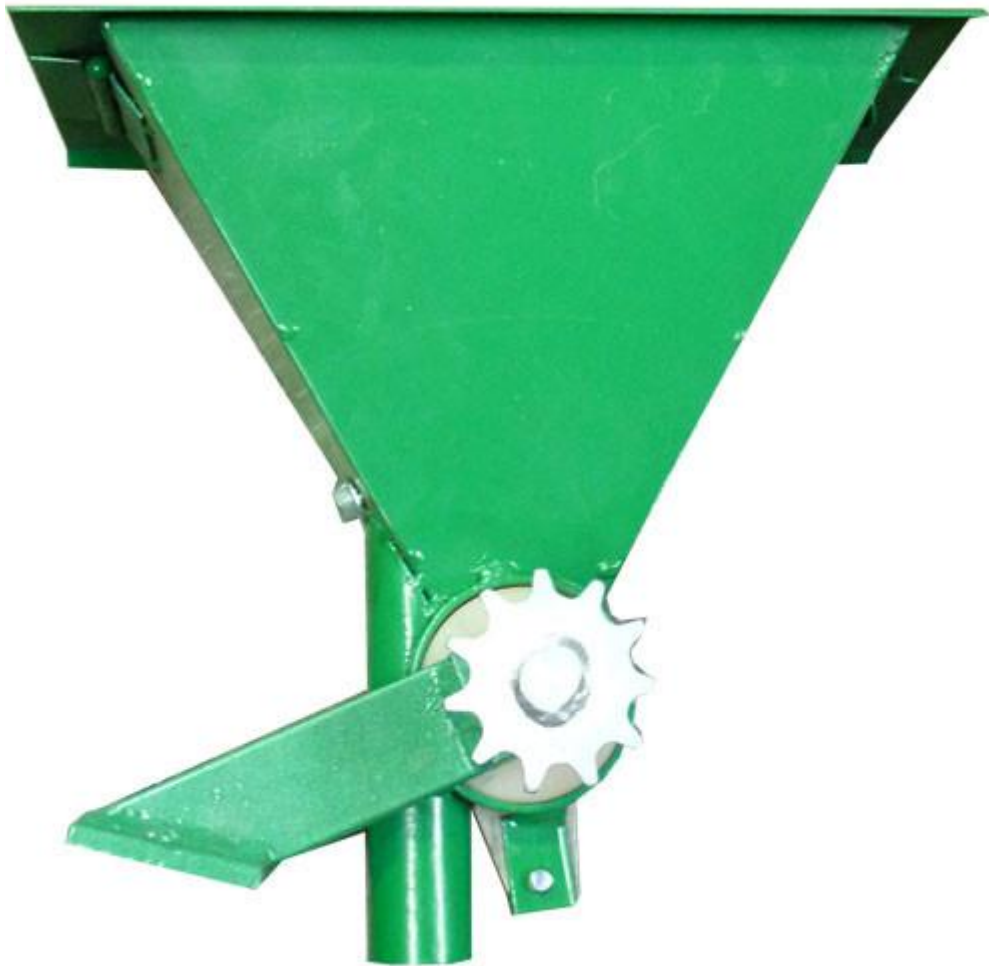
Рис. 2.20. Загальний вид барабанного висіваючого апарату селекційної сівалки СОМ-3/2Х30 (вид збоку)
