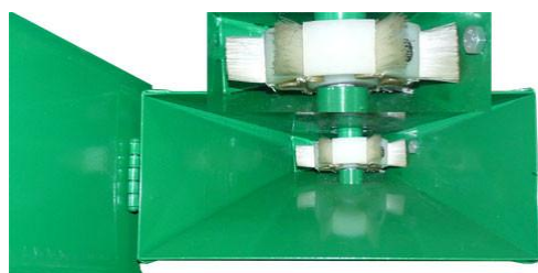
Рис. 2.17. Загальний вид щіткового висіваючого апарату селекційної сівалки СОМ-3/2Х30 (вид зверху)
