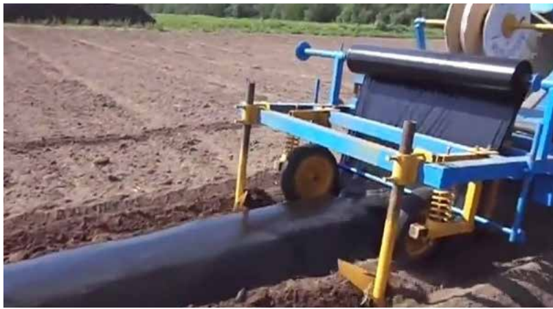
Процес формування гряди та укладання поливної стрічки та поліетиленової плівки механічним способом
