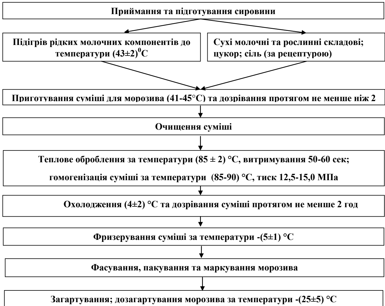
Рис. 1 Технологічна схема виробництва низькокалорійного молочного морозива
