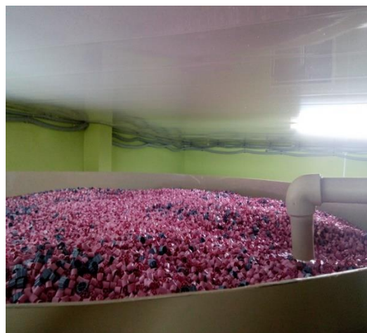
Рис. 18. Біофільтрація: а – біологічний фільтр; б – плаваючий наповнювач біофільтра
