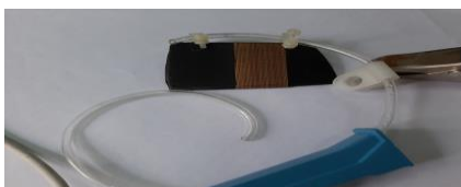
Рис.2. Зовнішній вигляд робочої скловуглецевої пластини.
