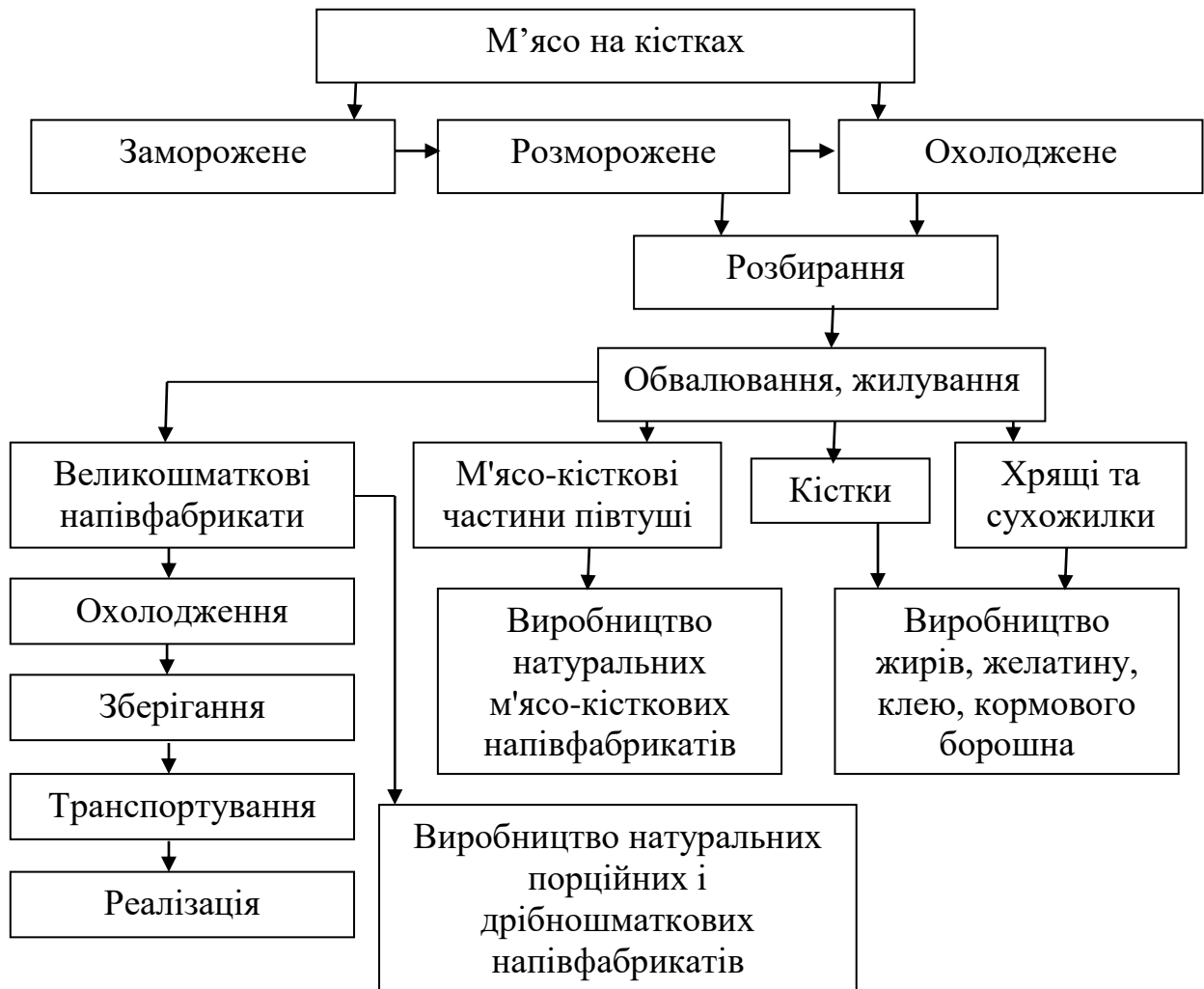
Рис. 3.6. Технологічна схема виготовлення натуральних напівфабрикатів
