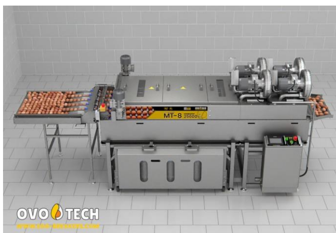
Рис. 3.5. Тунельна машина для миття яєць МТ-8 Ovo Tech.
