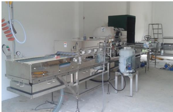
Рис. 3.6. Машина для миття яєць Nabel EWD 100.
