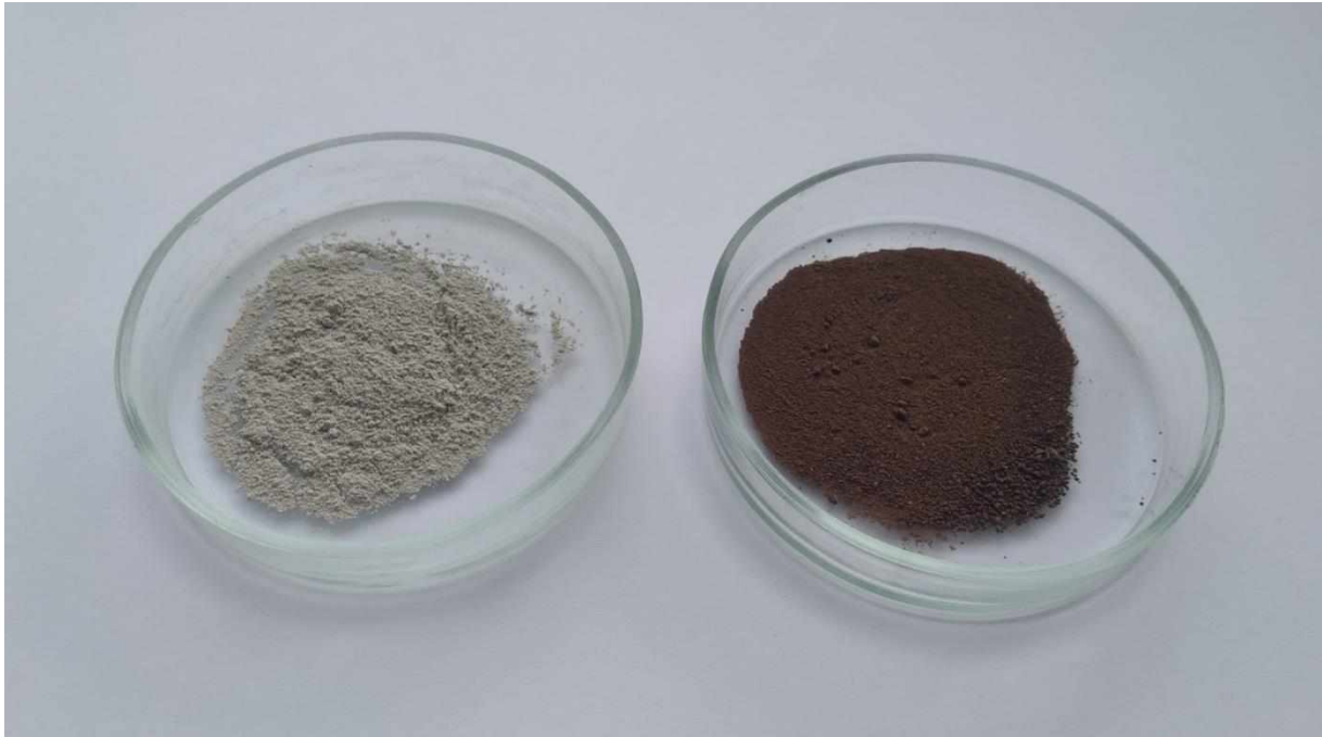
Рис. 1. Зовнішній вигляд цеоліту Сокирницького родовища Закарпатської області та цеолітовмісного базальтового туфу родовища «Полицьке–II» Рівненської області
